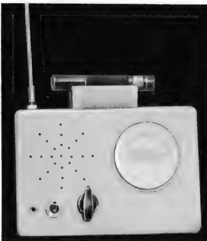
Bild 1. Ansicht des Fuchsjagd-Empfängers; das Gerät ist 180 mm breit
